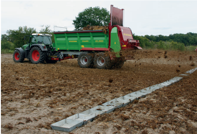
Bild 2: Mobiler Prüfstand zur Ermittlung der Querverteilung
