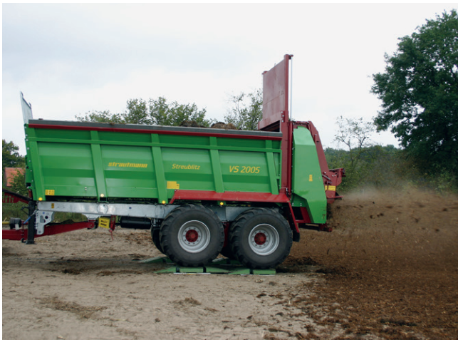
Bild 3: Strautmann VS 2005 auf dem Prüfstand zur Ermittlung der Längsverteilung
