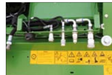
Werkzeuglos Schnellkupplungen der Hydraulikanschlüsse
