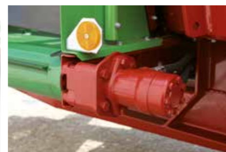
Silnik hydrauliczny – w zależności od warunków zastosowania istnieje możliwość wyboru w silnikach o różnej prędkości
