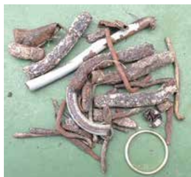
14 napos használat után a beépített mágnes ilyen mennyiségű fémet választott ki. ( lást: kép jobbra)
