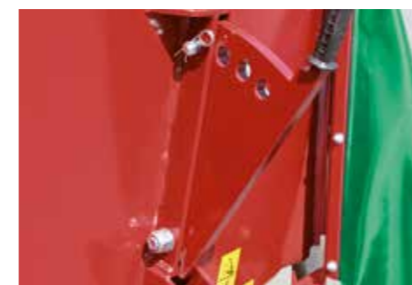
Gegenschneide (mechanische Verstellung)
