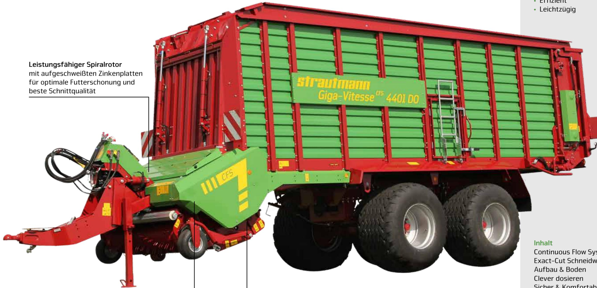
Leistungsfähiger Spiralrotor mit aufgeschweißten Zinkenplatten für optimale Futterschonung und beste Schnittqualität
