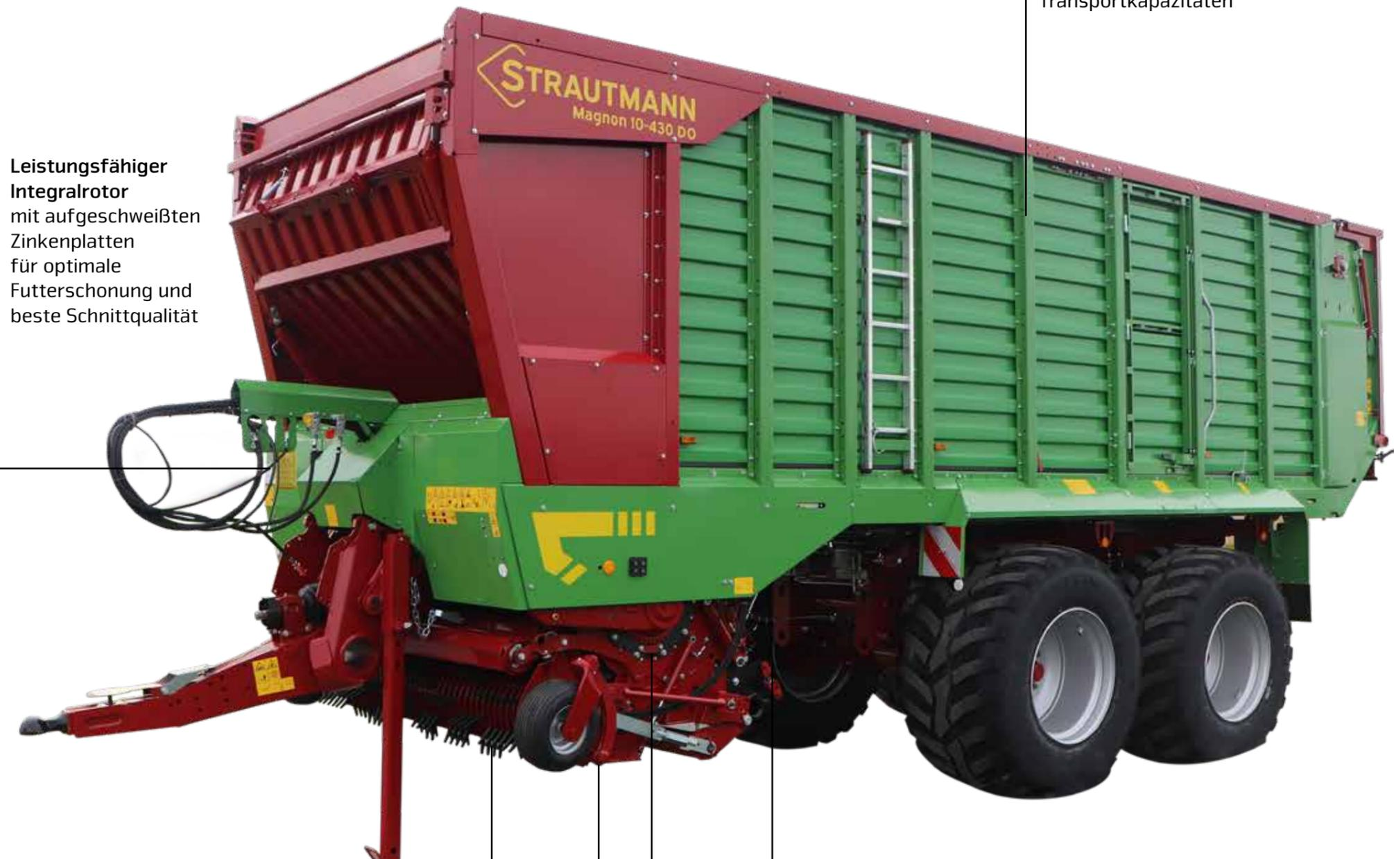
**Leistungsfähiger Integralrotor** mit aufgeschweißten Zinkenplatten für optimale Futterschonung und beste Schnittqualität
