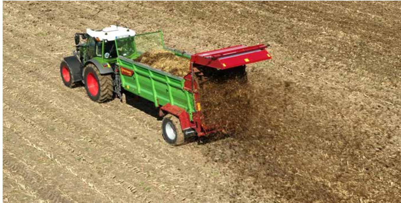
Le dispositif d'épandage à quatre hérissons des épandeurs MS se prête parfaitement à l'épandage de fumier solide. La faible puissance requise permet d'obtenir un rendement élevé tout en assurant une répartition transversale fine et homogène.
