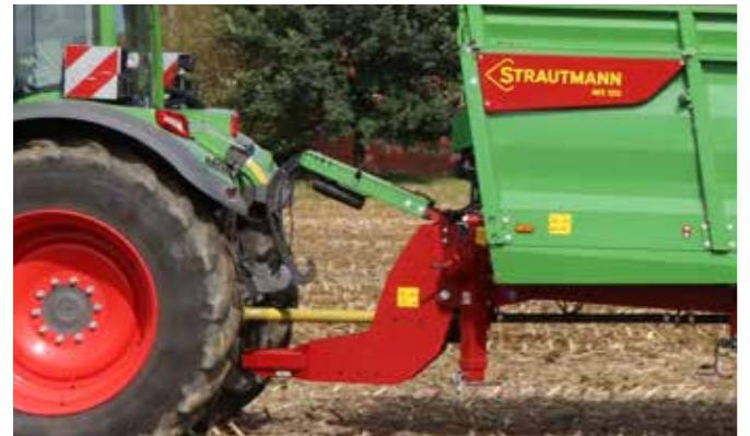
Selon les exigences, les épandeurs MS peuvent être équipés d'un attelage haut ou bas. Le timon du MS 120 est équipé d'une suspension mécanique qui confère à l'épandeur des caractéristiques de conduite optimales.
