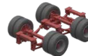
Ensemble à 4 ou 6 ressorts uniquement sur Verti-Mix Triple
