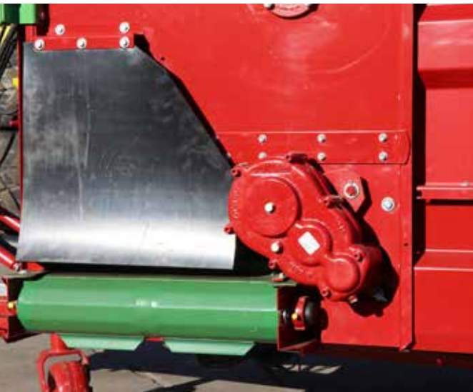
Une Distribution confortable Le bloc de silo est désagrégé de manière fiable dans le BVW et l'UBVW, puis acheminé de manière homogène par le convoyeur transversal. Cela garantit une distribution rapide et sans perte du fourrage directement dans l'étable.
