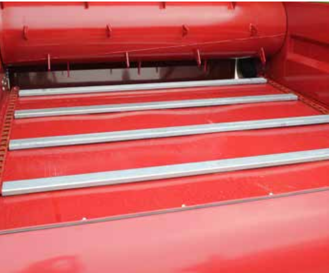
Tapis de transport Le tapis de transport est équipé de larges barres de transport galvanisées à chaud. La vitesse peut être réglée en continu depuis le tracteur à l'aide d'un câble Bowden.
